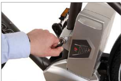
Oplåsning af batteriet
